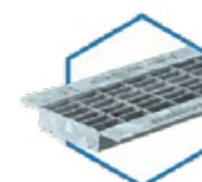
1 griglia zincata B125 fissaggio 4 bulloni maglia 30x10 antitacco
